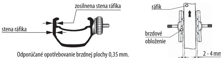
Gumové brzdové obloženia majte nastavené 2 – 4 mm od ráfika s miernym sklonom podľa obrázku. Kontrolujte ich opotrebovanie a ak je to nutné, vymeňte ich. Očistite olej alebo nečistoty nahromadené na ráfiku aj na upevneniach obložení.
