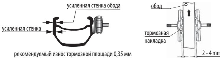
Тормозную колодку удерживайте в расстоянии 2-4 мм от обода с небольшим наклоном согласно рисунку. Проверяйте их износ и в случае необходимости, замените их. Очистите масло или загрязнение, находящееся на ободе и на тормозных колодках.
