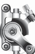
nastavenie sklonu brzdového strmeňa voči kotúču
