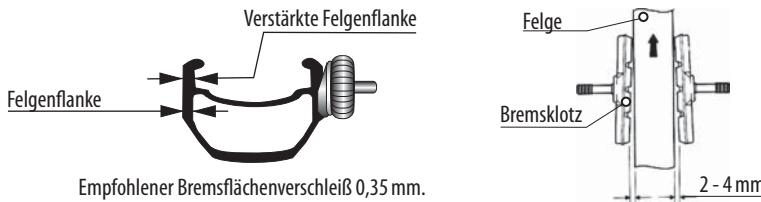
Halten Sie die Bremsklötzte 2-4 mm von der Felge eingestellt. Prüfen Sie den Verschleiß der Bremsklötzte und wechseln Sie diese bei Bedarf. Reinigen Sie Öl oder Schmutz auf Felgen und Bremssockeln. Sehr wichtig ist eine genaue Einstellung der Bremsen hinsichtlich des Bremshebel-Bewegungsbereichs, um die volle Bremskraft im Rahmen dieses Bereichs zu nutzen.
