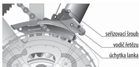
řídí pohyb řetězu po třech předních převodnících. Pohybem levé páky vpřed se řetěz přesune z menšího převodníku na větší. Brzy se naučíte, které pozice používat pro různé podmínky jízdy. Jedině procvičováním se to dobré naučíte. Nesnažte se přehazovat ve chvíli, kdy vyvijíte velký tlak na pedály. Nikdy nešlapte zpět, když přehazujete. Mohl by vám spadnout řetěz.
