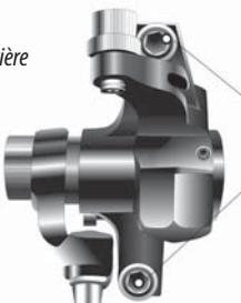
réglage de l'inclinaison de l'étrier de frein par rapport au disque de frein
