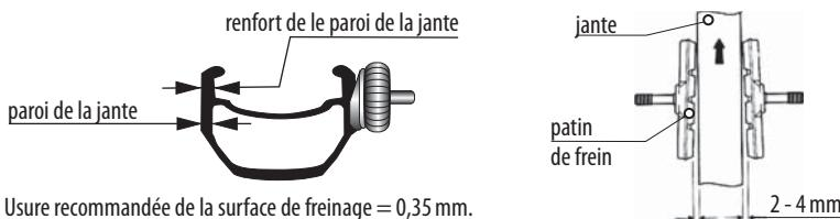
Gardez les patins de frein réglés à une distance de 2-4 mm de la jante, avec une légère inclinaison selon la figure. Contrôlez leur usure et si nécessaire, remplacez-les. Enlevez l'huile ou les impuretés accumulées sur la jante et le patin de frein.
