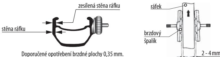
Udržujte brzdové gumičky nastavené 2–4 mm od ráfku s mírným sklonem dle obrázku. Kontrolujte jejich opotřebení a je-li to nutné, vyměňte je. Očistěte olej nebo nečistotu nahromaděnou na ráfku i na brzdových botkách.
